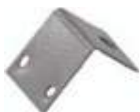
CH6 - Gal Chapinha Nº 06 22x30mm furo: 8 e 5,5mm largura: 31mm Material: #18
